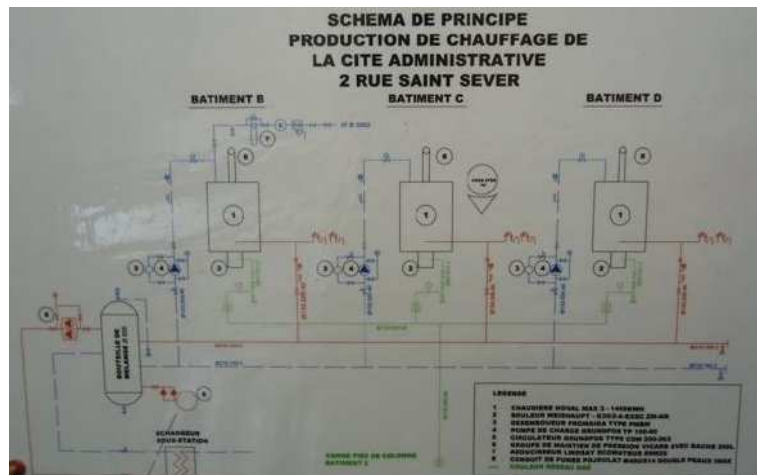
Figure 9 : Schéma de principe du réseau de distribution
