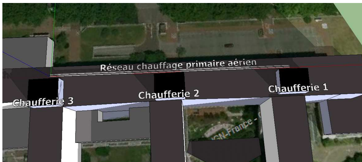
Figure 12 : Réseau primaire aérien (appelé réseau 1)
