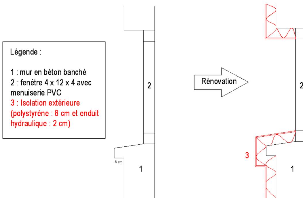
Remarque : penser à une pente de 2 % pour l'écoulement des eaux pluviales sur les rebords de fenêtre. Pensez à isoler les retours de fenêtres pour éviter la création de ponts thermiques importants
