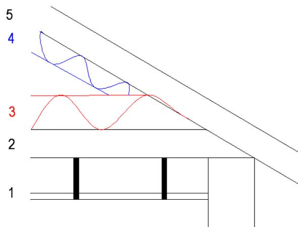
Pour les toitures à pans (combles non utilisables), il est préférable d'isoler le plancher haut plutôt que la toiture.
