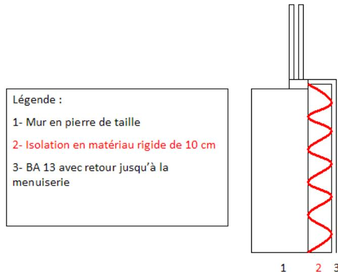
Il est important que l'isolation par l'intérieur couvre le rebord de fenêtre afin d'éviter la création de ponts thermiques. De même pour la partie haute de la fenêtre, l'isolant doit revenir jusqu'aux menuiseries.
