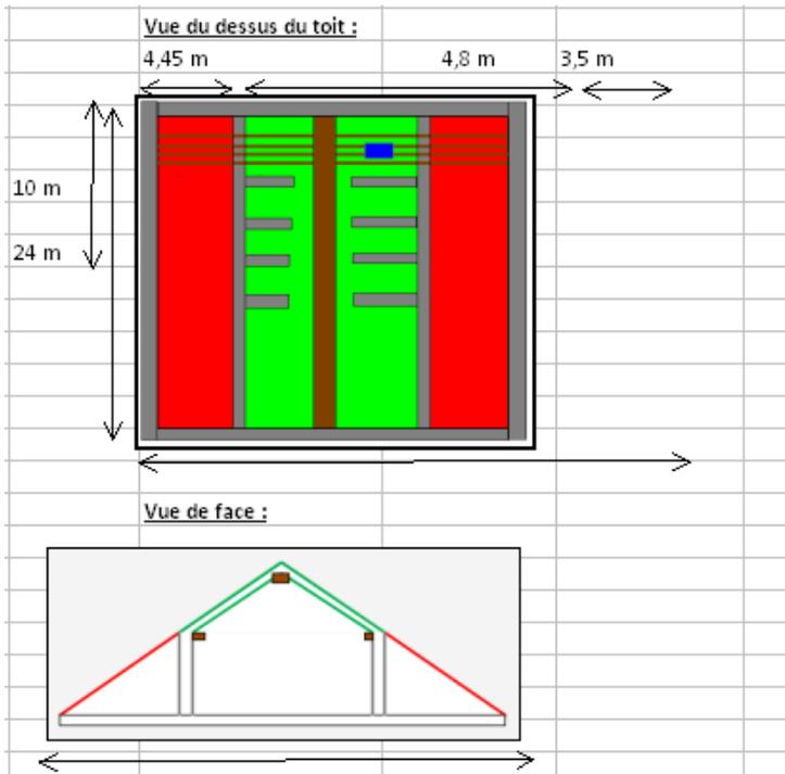
La partie de la toiture qui est isolée correspond aux parties vertes du schéma et les rouges correspondent aux non isolées.
