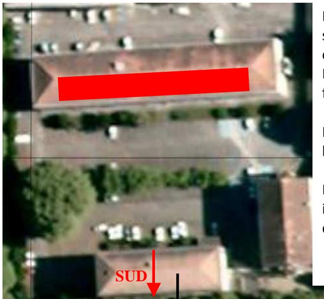
Notre choix d'installation des capteurs se porte sur la partie de toiture exposée au Sud et ne comporte pas de masques lointains (hormis la DDAF, qui est trop petite en hauteur et donc ne forme pas de masque gênant).
